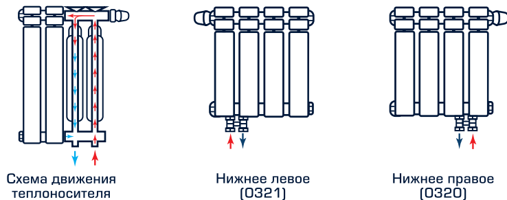
Рис. 4. Возможные схемы нижнего подключения (0320/0321) радиаторов STOUT TITAN VENTIL к трубопроводам системы отопления
