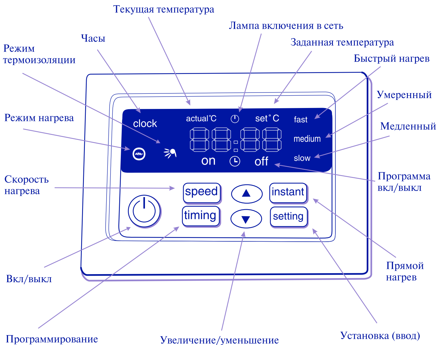
Рис.1. Расположение функциональных кнопок блока управления.
