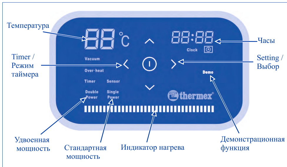
Рис. 6. Электронная панель управления (вариант 2)
