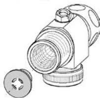
Установка ограничителя расхода
